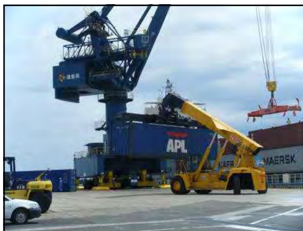
リーチスタッカー
