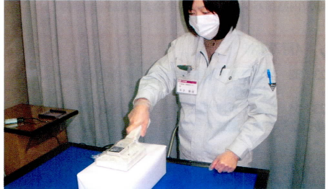
市環境監視センターにおいて工業製品の残留放射線を測定
