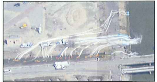
ポンプ車(60m 3 /min、40m 3 /min、30m 3 /min級)稼働状況
