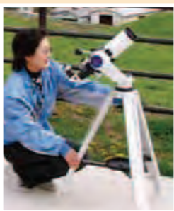
H \alpha 太陽観察専用望遠鏡
