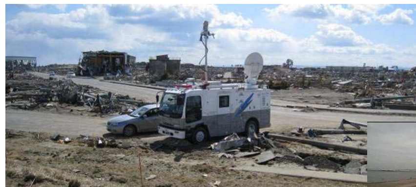
被災したCCTVカメラの機能を代替する衛星通信車
